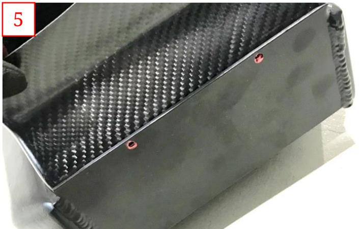
Positionieren Sie die WAGNERTUNING Ladeluftkühler und Luftführungen mit den beigefügten M8 Schrauben, Scheiben und Muttern.
